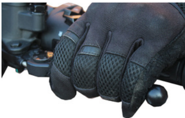
Zadní brzda se ovládá levou pákou.
