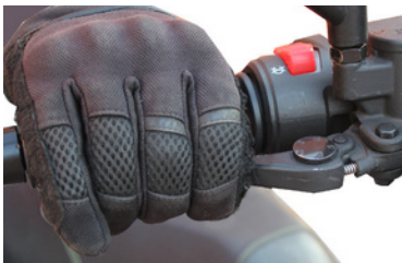
Přední brzda se ovládá pravou pákou.
